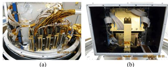
图 3 (a)4K 到 1K 温区 38 AWG 规格 NbTi 双绞线<sup>[21]</sup>;
